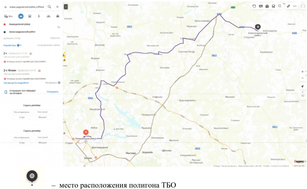
Рисунок 1 – Транспортная схема вывоза строительного мусора с площадки строительства на полигон твердых бытовых отходов (плечо перевозки 140 км)
